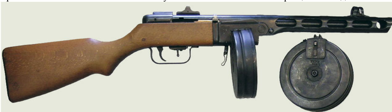
ППШ ранних выпусков с дисковым магазином на 71 патрон и секторным прицелом с десятью делениями для стрельбы на дистанцию от 50 до 500 м.
