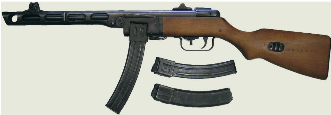
ППШ-41 с секторным магазином на 35 патронов, прицелом в виде поворотного целика для стрельбы на 100 и 200 м, более надежной защелкой магазина, хромированной поверхностью канала ствола.
