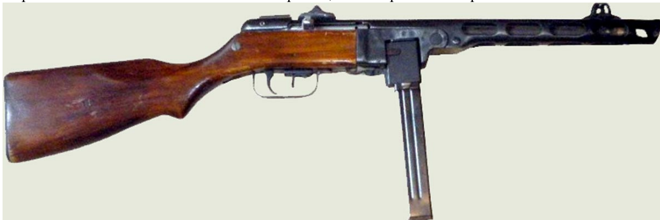
MP41(r) – немецкая переделка ППШ под патрон Parabellum
