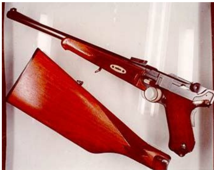
Коммерческий карабин Parabellum калибра 7.65mm Luger/Para с автоматическим предохранителем на задней стороне рукоятки.
