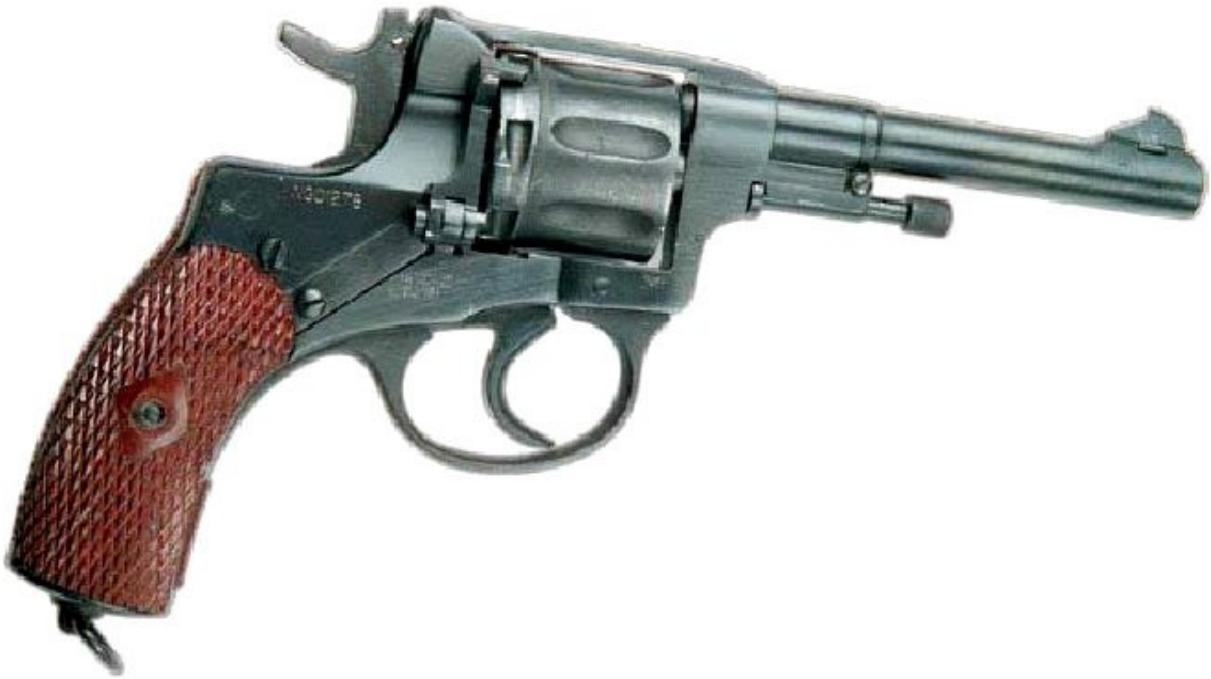
**Револьвёр** (от [лат. revolvere](#) — катить назад, вращаться) — многозарядное [огнестрельное оружие](#) ближнего боя, [механизм питания патронами](#) которого выполнен в виде вращающегося [цилиндра \(барабана\)](#), <sup>III</sup> в [каморах](#) которого находятся [патроны](#), при этом, в момент выстрела, [ствол](#) является продолжением очередной каморы.
