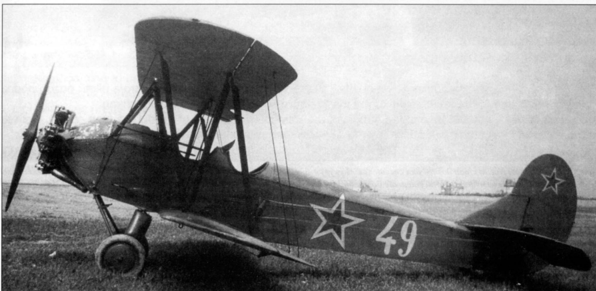
В мае 1945 года советские «Кукурузники» появились на территории Чехословакии. Машина на снимке, сделанном на одном из пражских аэродромов, довольно долго находилась в эксплуатации, о чем можно судить по облезлому капоту и отсутствию подкрыльевой дужки.
