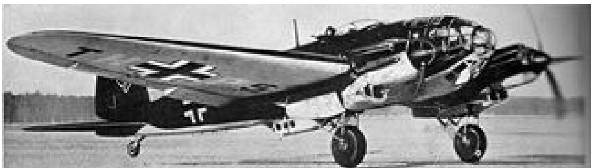
Самолет Хейнкель Хе-111 Н-11 выпуска 1942 г. представляет собой двухмоторный непикирующий бомбардировщик цельнометаллической конструкции с бесформенной кабиной, с низкорасположенным крылом и с неразнесенным хвостовым оперением (фиг. 44). На нем установлены перевернутые моторы ЮМО-211 F-1 жидкостного охлаждения с непосредственным впрыском горючего.
